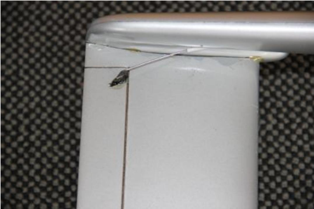
Das Höhenservokabel verlängern, da der Empfänger seinen Platz im Cockpit Finden wird. Danach den Servoarm neutral stellen und den Stahldraht in das untere Loch einfädeln. Nun Servo und Höhenruder nochmal neutral einstellen und das Servo gemäss Foto einkleben. Zur Sicherung des Servo mit einem Stück Balsa nach oben versperren, resp. verstreben.
