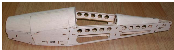
27. Glue plywood servo trays(F42).
