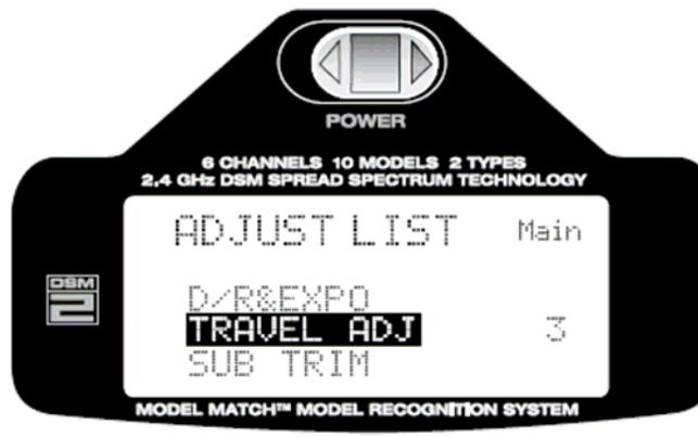
Durch Drücken der Taste aktivieren Sie die „Travel Adjust“ Funktion
