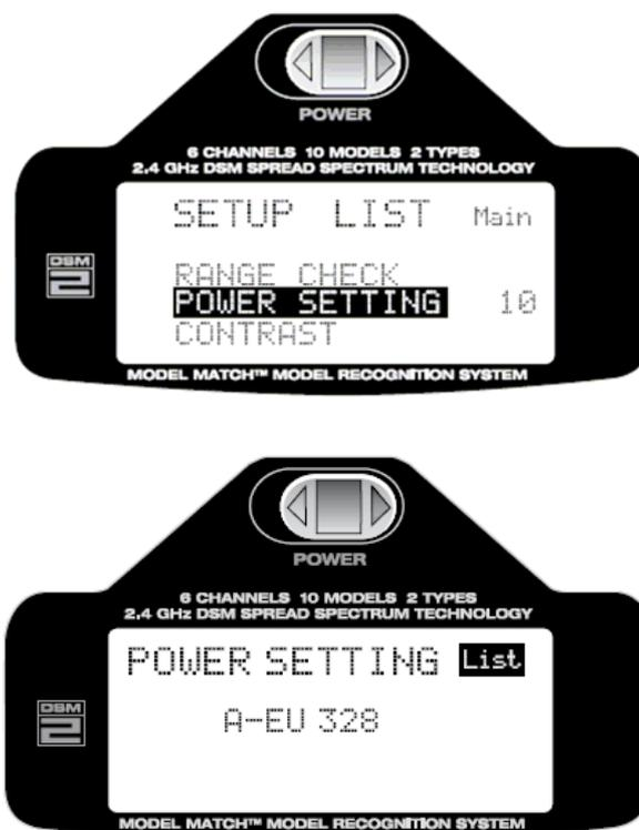
Mit der Roll-Funktion der Roll-Drucktaste aktivieren Sie die Anzeige in der zweiten Zeile. Durch Drücken der Taste und anschließendes rollen, können Sie zwischen beiden Einstellungen Auswählen. Wählen Sie hier A-EU 328 aus und bestätigen Sie die Einstellung durch Drücken der Taste. Beachten Sie unbedingt die Hinweise in der Einleitung zu diesem Menüpunkt.
