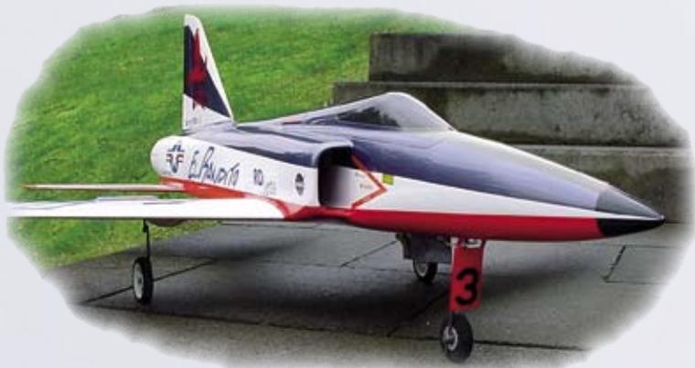
Das pneumatische Springair Einziehfahrwerk ist als Zubehör erhältlich. **Best. Nr. FJ1002**
