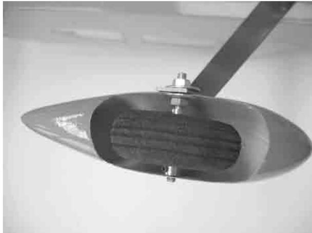
Die Schlitz für Höhen- und Seitenflosse am Rumpfeende ertasten und mit dem heißen LötKolben herausschmelzen.
