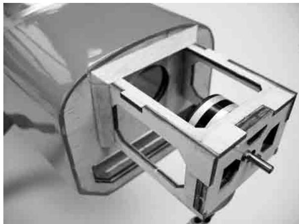
Nach dem Trocknen des Klebstoffes die Motorhaube aufschieben und den Spinner zusammen mit der Luftschraubenkupplung auf die Motorwelle schieben.
