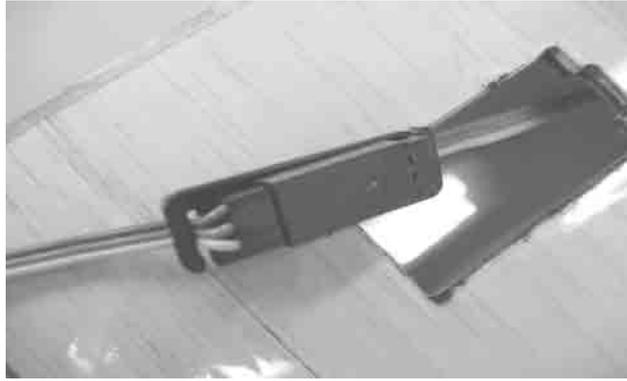
Servos in die Aussparungen stecken, Befestigungslöcher mit  $\varnothing$  1,5 mm vorbohren und Servos mit den den Servos beiliegenden Schrauben befestigen.
