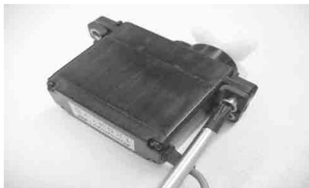
Servoanschlusskabel mit Verlängerungskabel Best.-Nr. 3935.32 verlängern, gegen lösen sichern (z.B. mit Sicherungsclip Best.-Nr. 3503) und in den Tragflügel einziehen.
