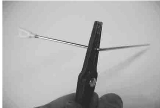
Sicherungsclip aufstecken und das Gestänge soweit kürzen das es noch ca.1 mm übersteht.
