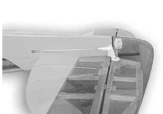
Wie auf den nachfolgenden Fotos zu sehen das Spornfahrwerk am Rumpf und Seitenruder montieren. Für die Schrauben entsprechend vorbohren.
