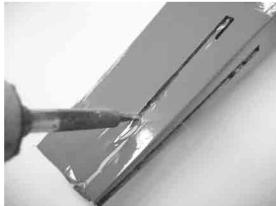
Seiten- und Höhenflosse in die Schlitz stecken und wie auf dem Foto markiert ausrichten.
