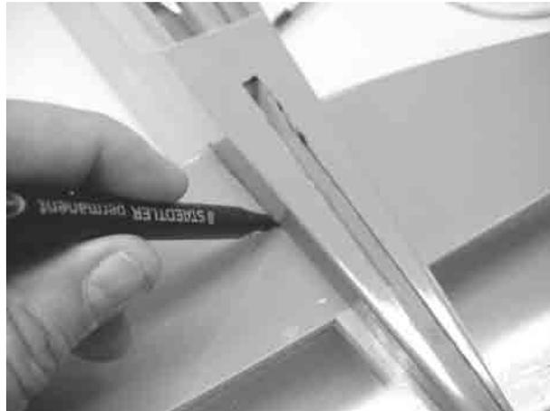
Mit dem heißen Lötcolben, etwas kleiner als angezeichnet, die Folie durchschmelzen und von den Bauteile ablösen.
