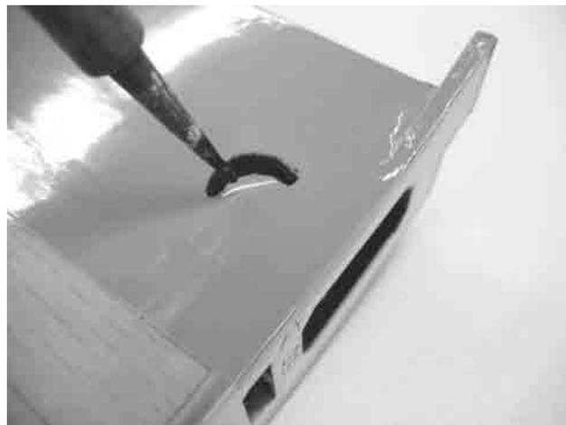
Gummitüllen und Hohlrieten in die Servoflansche stecken.
