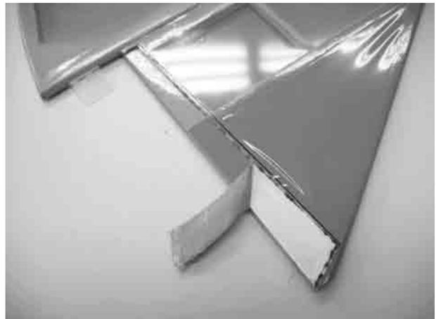
Nach dem Ablösen der Bespannfolie die Leitwerke wieder in die Schlitze im Rumpf schieben, ausrichten und festkleben. Das Seitenleitwerk muss mit dem Höhenleitwerk einen rechten Winkel bilden (mit Geo-Dreieck kontrollieren)
