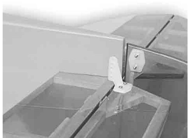
Die beiden Gestänge mit aufgedrehten Gabelköpfen vom Rumpffende aus in die Führungsröhrchen schieben Gabelköpfe einhängen und mit Silikonringen gegen öffnen sichern.
