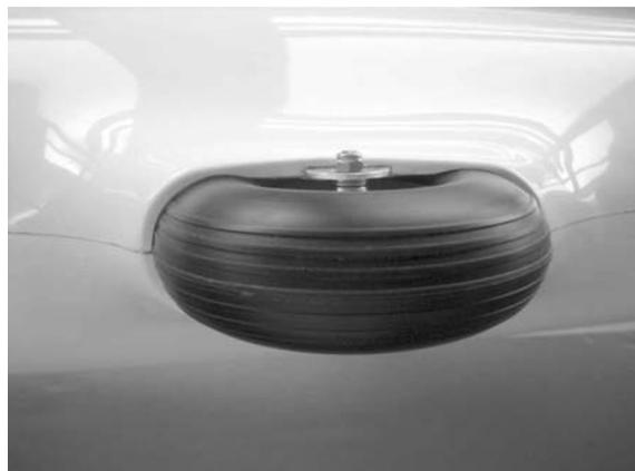
Das Spornrad wird auf die gleiche Weise befestigt mit dem Unterschied, dass eine M3 Inbusschraube mit STOP Mutter und U-Scheiben verwendet wird.
