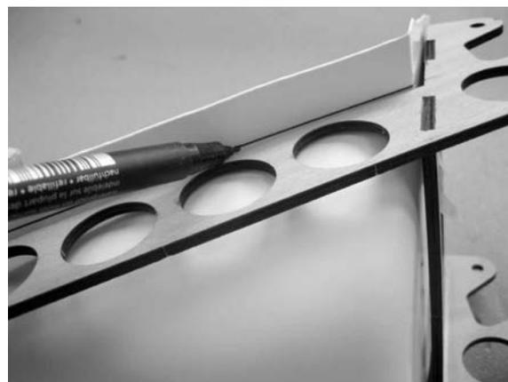
Die beiden Sitze sollten mit der Außenkontur der Halterung übereinstimmen. Verklebt werden die beiden Sitze mit der Halterung mittels UHU hart Klebstoff. An den vorderen Spant und den schrägen Abschluss wird wie auf dem Foto zu sehen der Instrumentenpilz geklebt.
