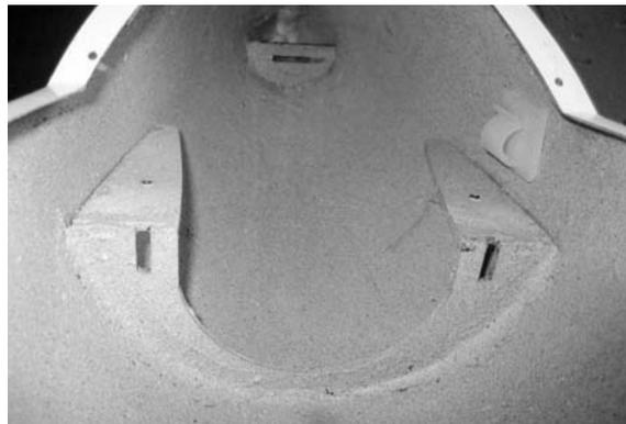
Die Empfängerhalterung, Servobrettchen für Höhen -und Seitenruderservo sowie die Schalterhalterung in den Rumpf kleben. Wie schon zuvor beschrieben, die Teile mit Sekundenkleber anheften und anschließend mit Zweikomponentenkleber mit dem Rumpf verkleben.
