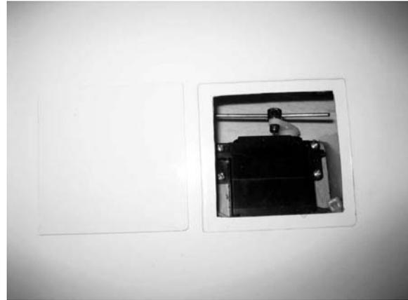
Bei Servo und Querruder in Neutralstellung die Gestänge anfertigen und in der Länge einstellen.
