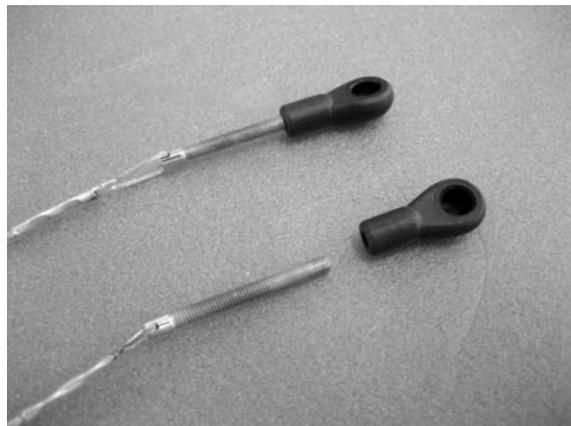
Die Aluminiumbuchsen werden mittels einer Flachzange gequetscht und die Schlaufe des Stahlseils zusätzlich durch Zusammenlöten gesichert. Die Kunststoff-
