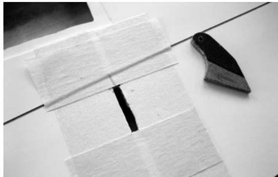
Den Klebstoff am besten mit einer Spritze in die Querruder drücken, um ausreichend Klebstoff an die Klebstellen zu bekommen. Ruderhorn dünn mit Klebstoff an den angeschliffenen Stellen einstreichen und in den Schlitz stecken. Dabei darauf achten, dass das Ruderhorn an der oberen Schale des Querruders anliegt. Nach kurzem Antrocknen den überschüssigen Klebstoff mittels der Klebebänder entfernen. Bis zum Aushärten des Klebstoffes das Ruderhorn in senkrechter Lage mit Klebeband sichern.
