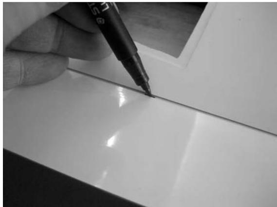
Mit einem GEO-Dreieck die Größe der Schlitz anzeichnen. Länge der Schlitz ca.18mm, Breite ca. 2 mm
