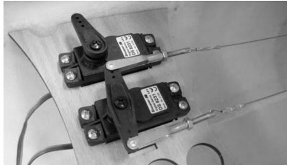
Die Seilzüge werden wie auf dem Foto zu sehen, an dem Servohebel befestigt. Gabelköpfe am Servohebel einhängen, Aluminiumbuchse aufschieben Seile durch die Querbohrung der Augenschraube und wieder durch die Aluminiumbuchse schieben, spannen und ebenfalls mittels der aufgeschoben Buchse festklemmen. Hierbei sollte sich das Seitenruder und das Servo in Neutralstellung befinden. Die Feinjustierung der Züge erfolgt durch Ein bzw. Herausdrehen der Gabelköpfe auf den Gewindebuchsen.
