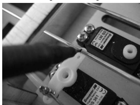
Bei Servo, Bugfahrwerk und Seitenruder in Neutralstellung wird das Bugfahrwerkgestänge mittels der Zylinderschraube festgeklemmt und die Länge des Seitenrudergestänges angezeichnet.
