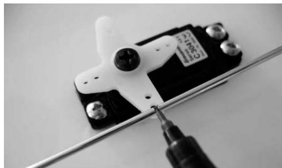
Mit einer Zange das Gestänge rechtwinkelig abbiegen. Das überstehende Ende des Gestänges wird soweit gekürzt, dass es noch ca. 1,5 mm über den Sicherungsclip hinaus steht.
