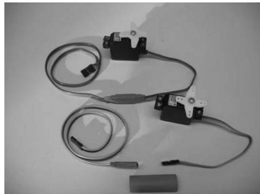
Wie auf dem nachfolgenden Foto zu sehen die Querruderservos in die Tragflügelhälften einsetzen und anschrauben.
