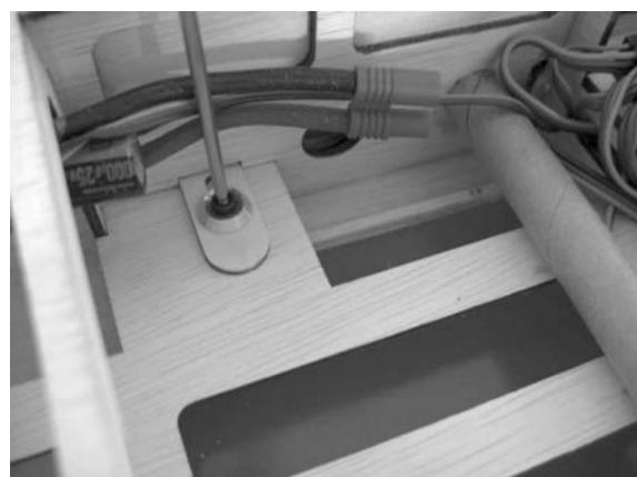
Die Schrauben nur so fest anziehen, dass die Tragflügelhälften unverrückbar am Rumpf anliegen.
