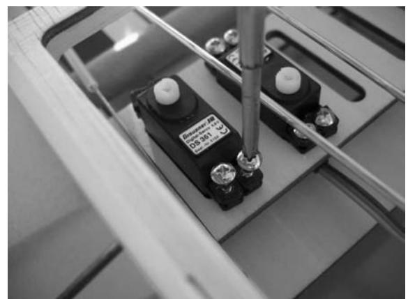
Die Einhängebohrungen an den Servohebeln mit Ø 2 mm aufbohren.
