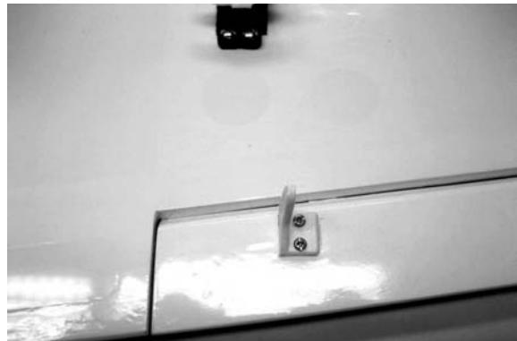
Ruderhorn mittels den beiden Schrauben und Gegenglatte anschrauben. Schrauben nur so fest anziehen bis das Ruderhorn unverrückbar befestigt ist. Schrauben auf der Oberseite mit einem Seitenschneider kürzen und mit der Gegenplatte bündig feilen.
