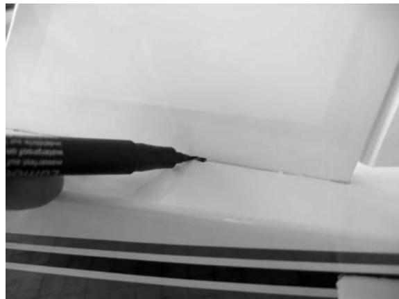
An einem Stahllineal entlang, etwas kleiner als angezeichnet, mit einem heißen Lötkolben die Bespannfolie durchschmelzen und von den Bauteilen ablösen
