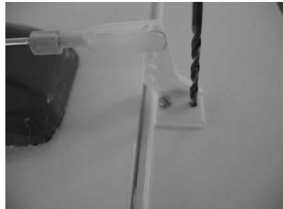
Ruderhörner anschrauben, überstehende Befestigungsschrauben mit einem Seitenschneider abschneiden und mit der Gegenplatte bündig feilen.
