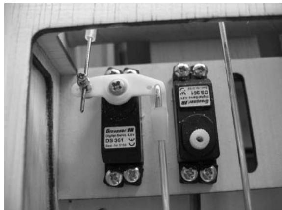
Beim Höhenrudergestänge wird auf die gleiche Weise das Gestänge eingehängt und gesichert, evtl. Ungenauigkeiten beim Abbiegen der Gestänge können durch Heraus bzw. Hineindrehen der Gabelköpfe korrigiert werden.
