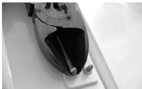
Auf die Seite des Anlenkgestänges mit Gewinde eine Mutter M2 und einen Gabelkopf aufschrauben.
