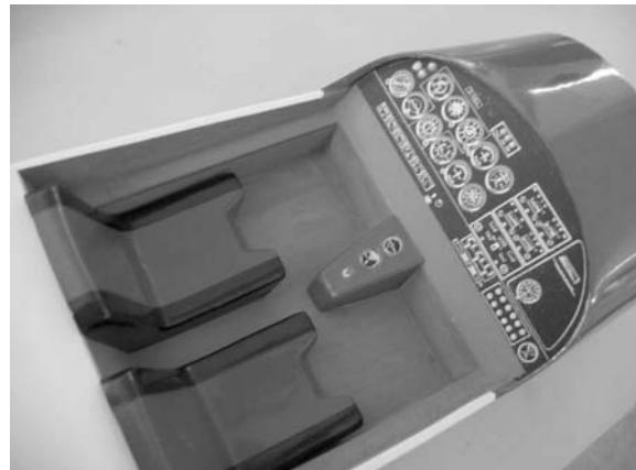
Die Kabinenhaube wird so auf die Rumpfabdeckung geschraubt, dass sie hinten mit der Rumpfabdeckung abschließt.
