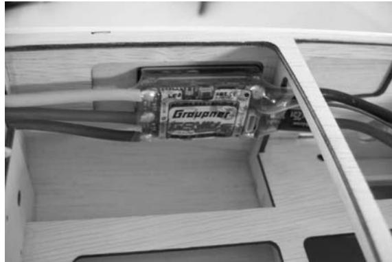
Zur Montage der Motorhaube wird auf den Rumpf Klebeband aufgebracht, so dass auf diesem das Ende der Motorhaube angezeichnet werden kann. Die Motorhaube so auf den Rumpf schieben, dass die Motorwelle genau in die Mitte der Öffnung kommt (mit Spinner-Grundplatte kontrollieren) Hierzu für den Bugfahrwerksdraht einen Schlitz in die Unterseite der Motorhaube feilen
