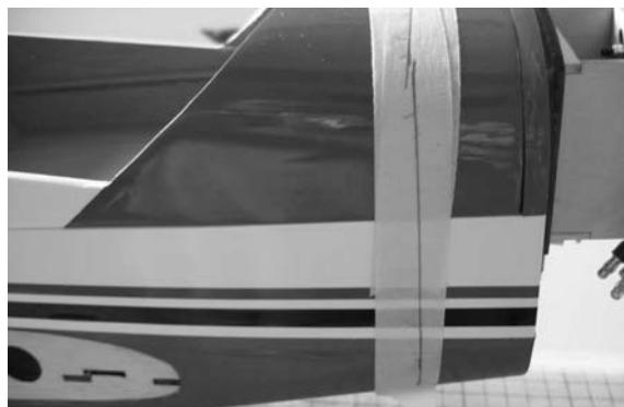
Von dieser Linie aus die Position der Befestigungsbohrungen ausmessen (rechts und links zwei Stück). Die Befestigungslöcher werden so in Motorhaube und Rumpf gebohrt, dass sie genau in der Mitte der Materialstärke des Kopfspantes kommen.
