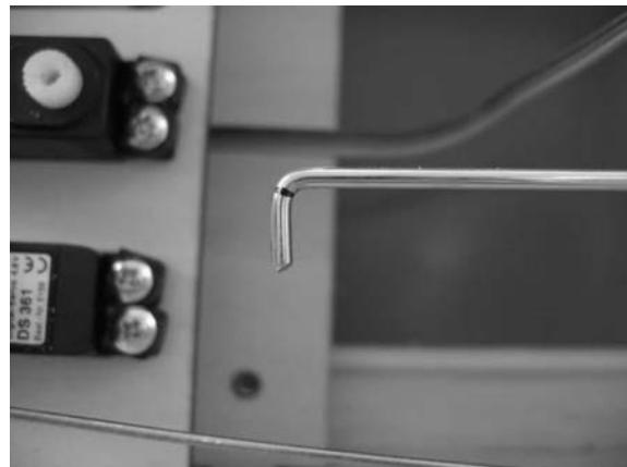
Gestänge in Servohebel einhängen und mittels Sicherungsclip gegen Lösen sichern
