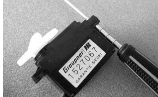
Die Servoanschlusskabel mit den entsprechenden Verlängerungskabeln (350 mm) verlängern und in die Tragflächenhälften einziehen, so dass der Anschluss aus der Bohrung in der Wurzelrippe herauskommt. Steckverbindung mit einem Tropfen Sekundenkleber oder Schrumpfschlauch gegen Lösen sichern.
