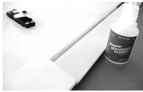
Jetzt die Position der Ruderhörner auf den Querrudern anzeichnen und mit Ø 2mm bohren. Hierbei darauf achten, dass zum Einen die Gestänge parallel zur Servoaußenkante verlaufen zum Anderen der Einhängepunkt des Gestänges mit dem Drehpunkt der Ruder übereinstimmt.
