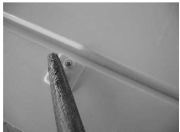
Die Servos für Seiten- und Höhenruder werden mittels den den Servos beiliegenden Schrauben, in das Befestigungsbrettchen im Rumpf geschraubt. Für die Befestigungsschrauben mit Bohrer Ø 1,5 mm vorbohren.
