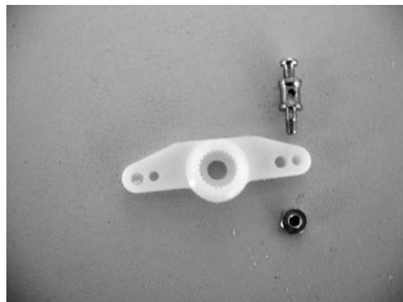
Jetzt wird der Servohebel so auf das Seitenruderservo montiert, dass das Anlenkgestänge durch die Querbohrung des Gestängeanschlusses geht.
