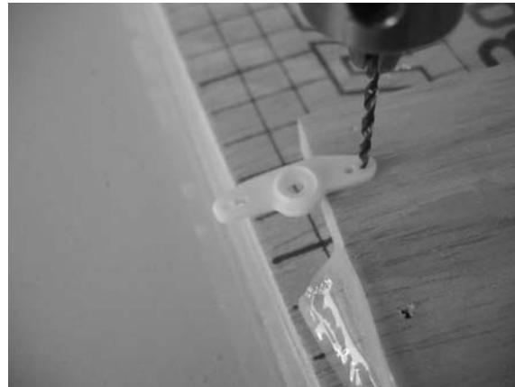
Zur Mitnahme des Bugfahrwerkgestänges wie auf dem Foto zu sehen den Gestängeanschluss montieren, dabei darauf achten, dass sich der Gestängeanschluss noch ohne merkliches Spiel drehen lässt. Mutter mit UHU schraubensicher gegen Lösen sichern.
