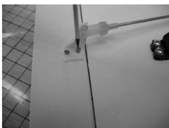
Bei Servo in Mittelstellung mit einem Filzstift die Länge des Gestänges anzeichnen.
