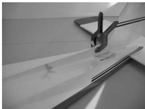
Nach dem Aushärten des Klebstoffes werden die Ruderhörner an Seiten- und Höhenruder montiert. Dabei darauf achten, dass sie mit den Gestängen fluchtend an die Ruder geschraubt werden. Hierzu die Gabelköpfe in die Ruderhörner einhängen. Grundplatte der Ruderhörner so auf die Ruder legen, dass der Einhängepunkt des
