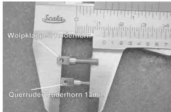
Jetzt die Ruderhörner bis auf Anschlag in die Ruder eindrehen. Darauf achten, dass sie rechts und links gleichweit eingedreht sind. Dies kann durch Kontrolle Abstand Endkante bis Einhängbohrung kontrolliert werden.
