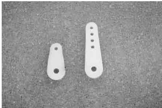
Bei Servomittelstellung wird der gekürzte Servohebel auf das Servo aufgesetzt. Hierzu das Servo mittels der Fernsteuerung in Neutralstellung bringen.
