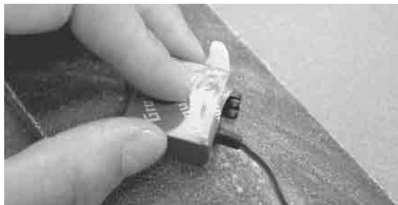
Auch bei den Wölbklappen muss der Steg vor den Rudern durchgebohrt und evtl. ausgefeilt werden.
