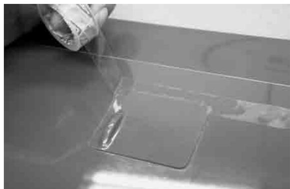
Wenn die Abdeckungen in die Vertiefung passen werden sie mit Klebestreifen angeklebt.
