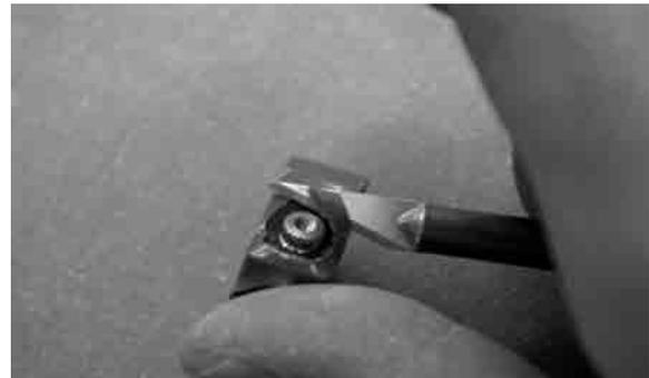
Um die Servo einschrumpfen zu können, muss der Schrumpfschlauch mit einer Zange etwas gedehnt, und der Servohebel abgenommen werden. Nach dem Abkühlen des Schrumpfschlauches den Schrumpfschlauch um das Abtriebsrad ausschneiden, auf Freigängigkeit des Servohebels achten. Bei Servomittelstellung den Servohebel aufstecken und sichern. Um das Servo einkleben zu können muss der Schrumpfschlauch angeschliffen werden.
