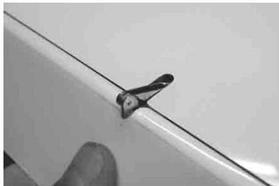
Jetzt werden die Gestänge von Servo zum Ruderhorn angefertigt. Sie bestehen aus zwei Gabelköpfen M 2,5 und einer Gewindestange M2,5 (von beiliegender Gewindestange abschneiden).
