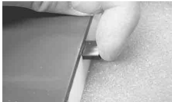
Die Buchsen der Verlängerungskabel werden in den Abschlussrippen(mit Sekundenkleber) festgeklebt.
