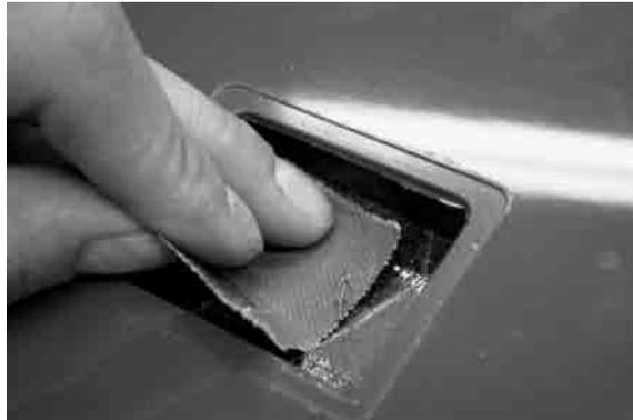
Für die Gestängedurchführung muss der Steg, vor den Rudern, entsprechend durchgebohrt und evtl. aufgefleilt werden
