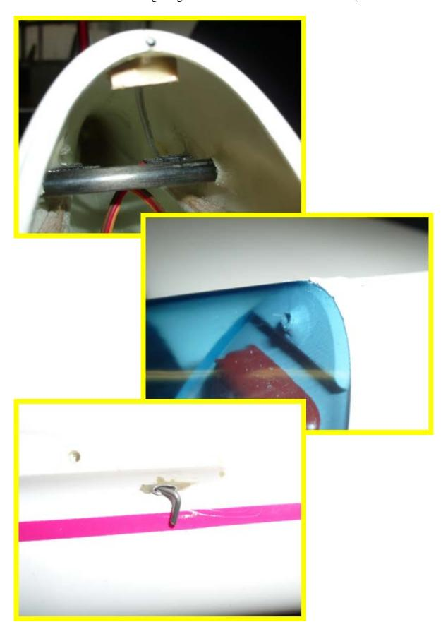
3.6. Kabinenrahmen und Kabinenhaube mit UHU Allplast zusammenkleben. An der Rand mit 5 mm Breiten Streifen von weisse Selbstklebende Folie.
