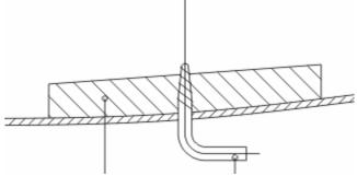
Buchsen von Querrudder Servo Verlängerungen im Rumpf kleben mit 5-Minuten Epoxy Kleber.
