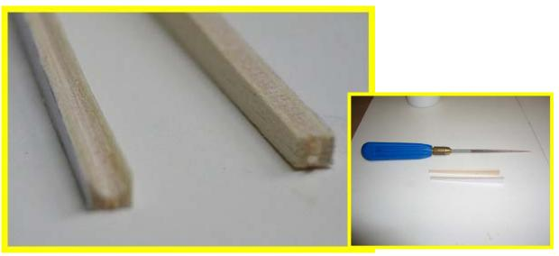
2.4. Eckigen Feile den Rand beim Sperholz Bowdenhälter feilen (mehr Oberfläche für Kleber!)
