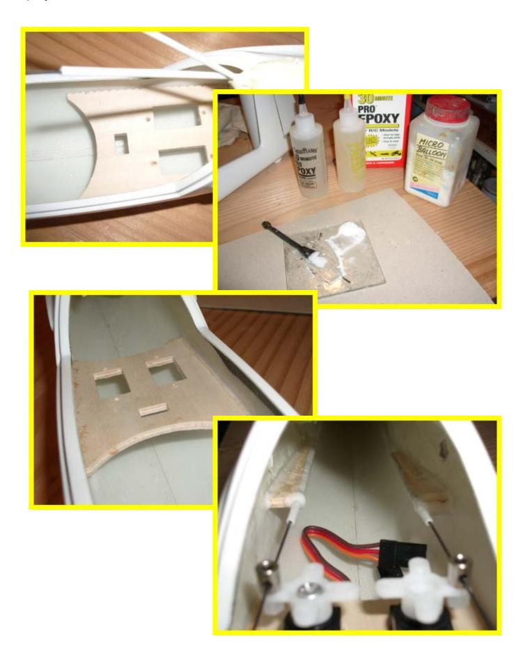
2.6. Höhenrudder Befestigungsteile sind am Foto 10 zu sehen (Schraube, Mutter und Carbon Stift)
