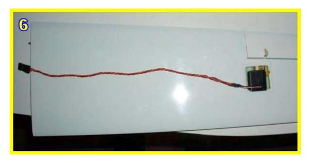
1.6. Servo zentireren und mit beilegenden Stahltdraht Servohorn und Querrudderhorn verbinden. Ein Tröpchen von Sekundenkleber am Querrudderhorn Ende an Stahldraht dient als Sicherung.
