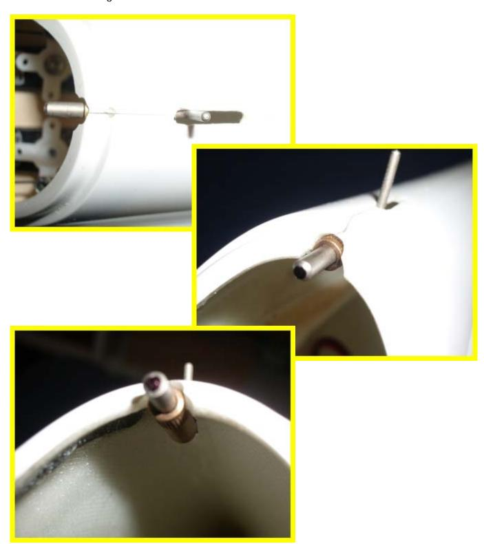
3.3. Vorne am Stift mit Schwarzen Filzstift und den Kabinenrahmen auf dem Rumpf schieben. Am markierte Stelle Durchbohren und nach Bedarf noch mit Runde Feile den Loch vergrösseren.
