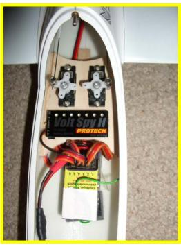
Für unser Test Modell haben wir Schulze Alpha 8 Empfänger verwendet mit Protech Volt Spy II Spannungsüberwachtung.
