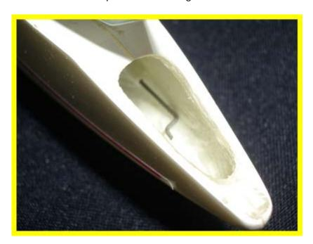
2.11. Die Mutter mit 5-Minuten Epoxy Kleber gemischt mit Microbalonen kleben. Vorher auf die Symetrie achten! Von Flügel Tip zu Höhenrudder tip sind 62.5 cm.
