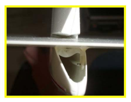
Mibo Modeli Micro Swift Bauanleitung, Version 1.0, 4.4.06 2.12. Für Seitenrudder ist kein Rudderhorn beigelegt. Der einbau erfolgt durch Messingröchen. Stahldraht am ende etwa 1 cm hoch verbiegen. Den Messingröhrchen mit Sekundenkleber im Seitenrudder fixieren und mit 5-Minuten Epoxy gemischt mit Microbalonen verkleben.
